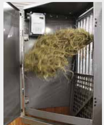
Die Steuereinheit löst die Verriegelung der Heuebene und das Futter fällt nach unten
