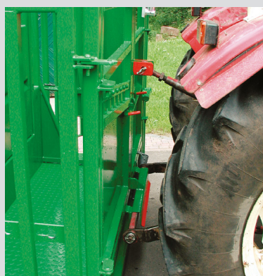
5 Transport über Ackerschiene und Oberlenker
